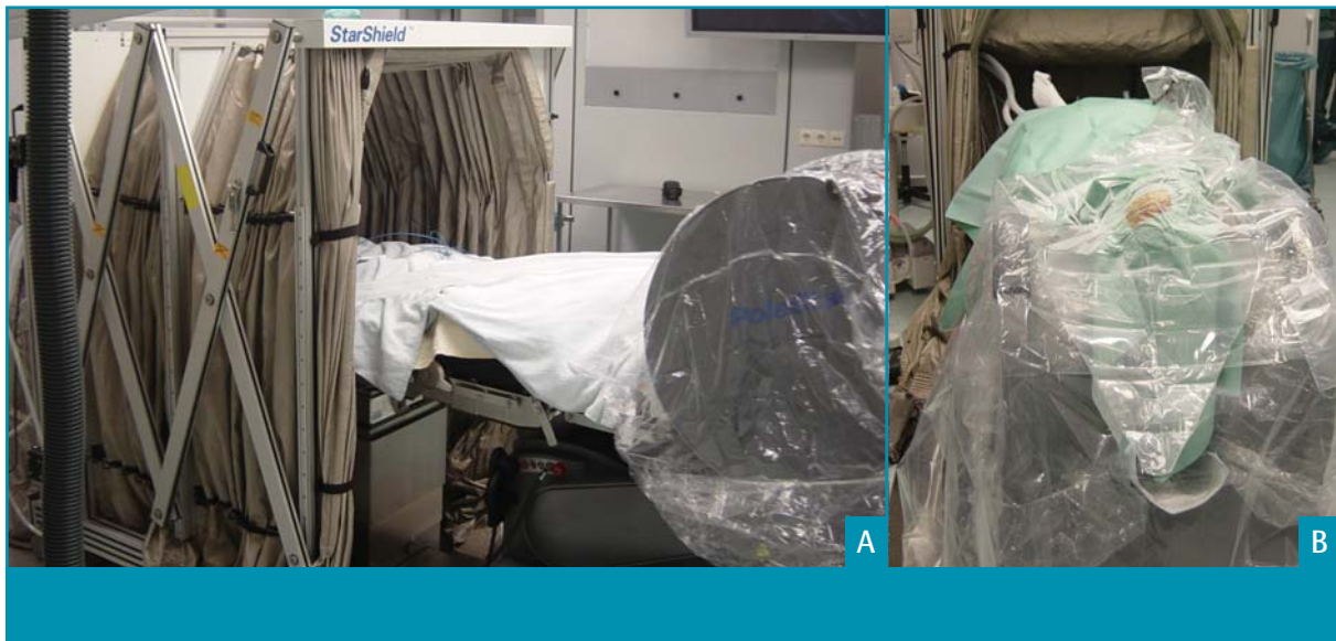
Figuur 2. A. Positie van de StarShield en de PoleStar tijdens de operatie. De StarShield vormt, wanneer hij is opengeschoven, een afscherming voor invloeden van buitenaf op het magnetische veld en is vergelijkbaar met een kleine kooi van Faraday. B. Positie van de patiënt in relatie met de MRI tijdens de operatie.
