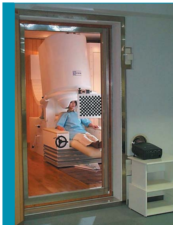
Figuur 2. MEG-opstelling in een magnetisch afgeschermd ruimte. Het stimulatieapparaat is buiten de kamer zichtbaar. De magnetische activiteit van de hersenen van de patiënt kan in zittende of liggende positie gemeten worden (bron: CTF-website: www.ctf.com ).
