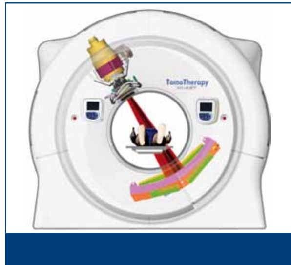
Figuur 2. Schema met linksboven het 6 megavolt (MV)-bestralingstoestel en rechtsonder de CT-detector.
