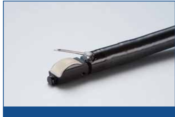
Figuur 4. Endobronchiale echoscoop (Pentax 1970UK). Ter hoogte van de distale tip bevindt zich een lineaire echotransducer met zijwaarts gerichte optiek en een werkkanal geschikt voor 21 en 22 Gauge-naalden.
